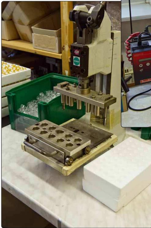
Die Presse bedient solche Verbindungen, die nicht per Spritzguss hergestellt werden
