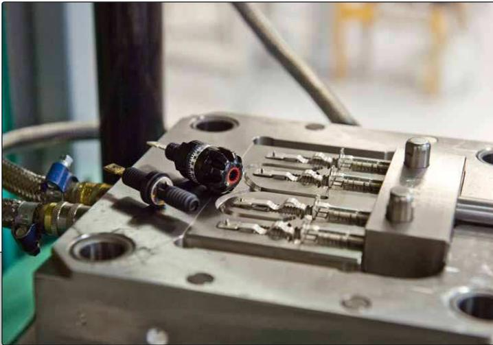
*Oben: Massivsilberkontakte in der Gussform, daneben ein fertiges und ein halbfertiges Produkt*
