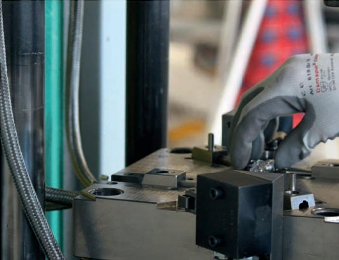
Hier wird gerade der Kunststoffkörper für den Bananenstecker WBT-0610 gefertigt. Im Bild ist nur eine der beiden Werkzeughälften zu sehen.
