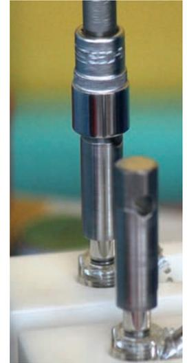
Bei den nextgen™ Verbindern nutzen wir reines Kupfer oder Feinsilber für den Signalleiter. Oben sehen Sie Fertigungsschritte der CE-konformen Bananenstecker mit Signalleitern aus Feinsilber.
