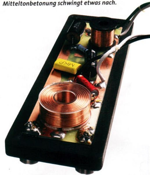
Die Frequenzweiche der Haydn Grand sitzt direkt auf der Innenseite der Rückplatte
