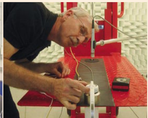
KLANGDOSE: Für On-Ear-Kopfhörer kommt eine Messschale ohne Ohrmodell zum Einsatz.
