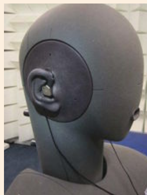
KOPFSACHE: Der Messkopf besitzt ein künstliches Ohr.
