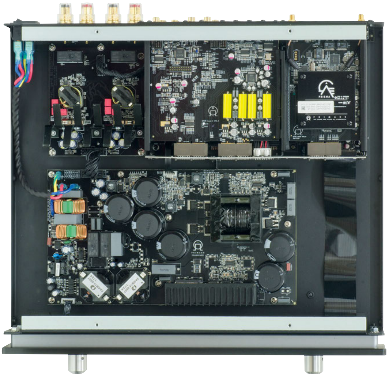
All'interno si apprezza la notevole pulizia e l'elevata qualità della componentistica. La scheda contenente i componenti della sezione di alimentazione è la più estesa (occupa infatti quasi la metà dello spazio interno) ed è collocata a ridosso del pannello frontale.
