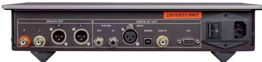
Neben USB, AES/EBU und koaxialen S/PDIF dient auch der proprietäre Playlink-Anschluss der Übertragung von Musik
