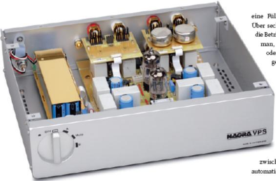
eine Fülle von Einstellmöglichkeiten. Über sechs Jumper pro Kanal lässt sich die Betriebsart variieren. Hier bestimmt man, ob mit oder ohne Übertrager oder mit einer Anpassungsplatine gehört wird. Die Anschlussart des Tonabnehmers wird eben-
