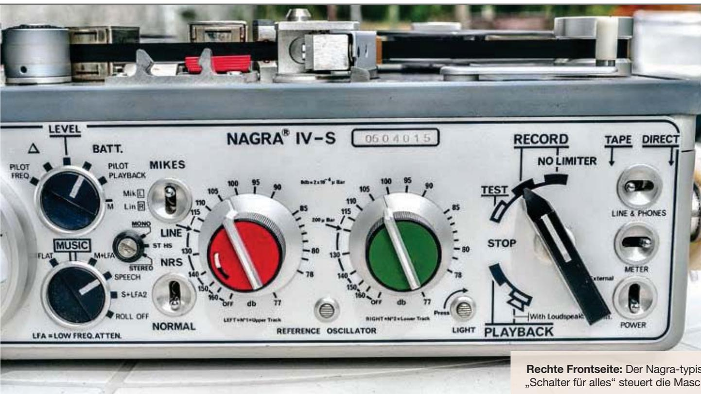
Rechte Frontseite: Der Nagra-typische „Schalter für alles“ steuert die Maschine
