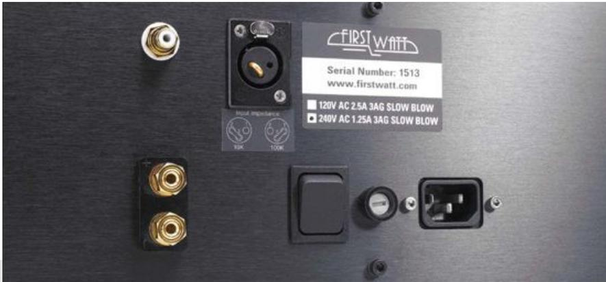
**SO RUM ODER SO RUM:** Durch Umstecken eines Kontaktbügels lässt sich für Quellen, die mit der hohen Eigangskapazität des Semisouth-JFETs nicht zurecht kommen, eine Zusatz-Transistorstufe aktivieren. Auf jeden Fall brennt die „Slow-Blow“-Sicherung bestimmt selten durch!
