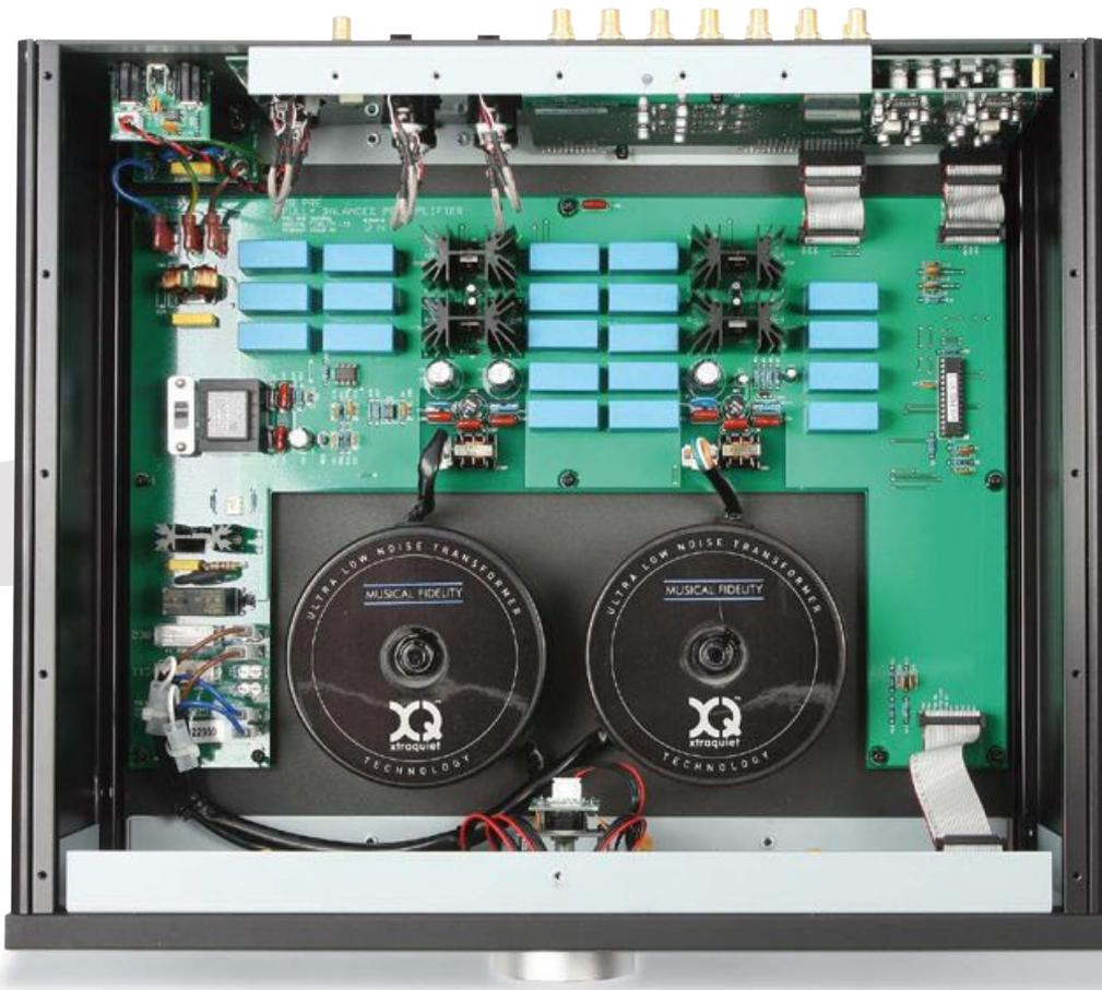
**VERSORGUNG HOCH ZWEI:** Die beiden Trafos werden von zahlreichen Säuberungs-Kondensatoren und Stabilisierungs-Stufen begleitet, die auf der großen Hauptplatine sitzen. Die Musiksignale zirkulieren nur über kurze Strecken auf der Rückseite herum. Ein Edel-IC regelt die Lautstärke.
