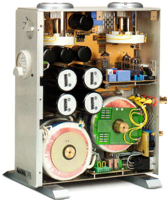
VPA: rechts im Gehäuse der massive Ringkern-Übertrager mit 4,8 und 16 Ohm
