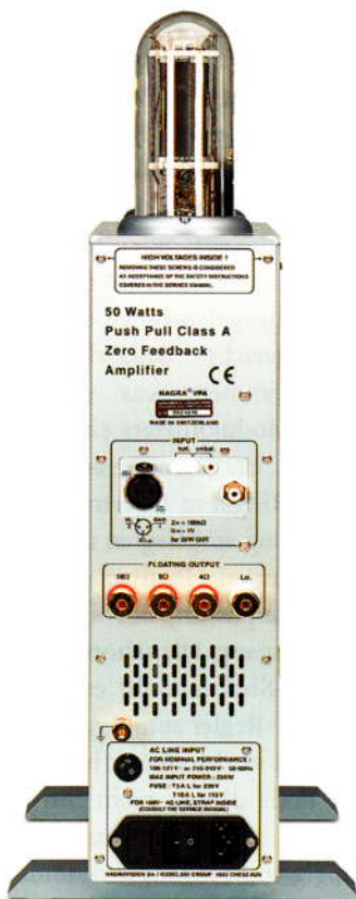
Beide Monos besitzen zusätzliche Masseanschlüsse in Form einer Polklemme
