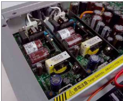
Zwei separate Netzteile versorgen Mainboard und Speichersektion getrennt voneinander
