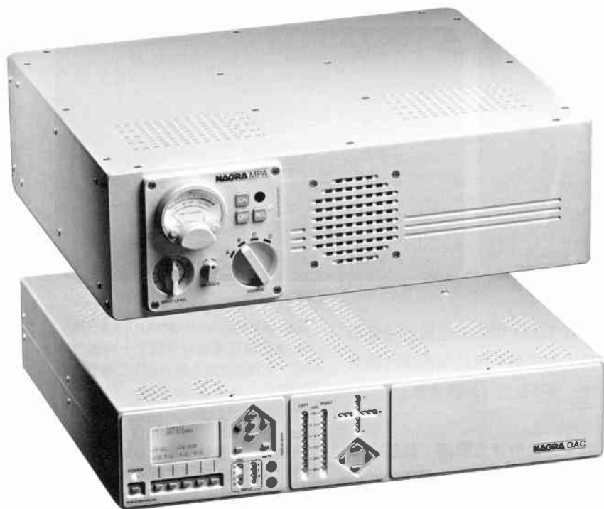
左上：Nagra MPA MOSFET後級，每聲道200瓦。
