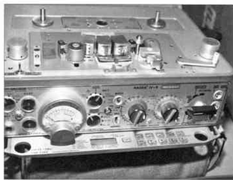
上：這是抽出控制盤的Nagra IV-S，控制盤上的按鍵已經是觸控的，質感很好。
