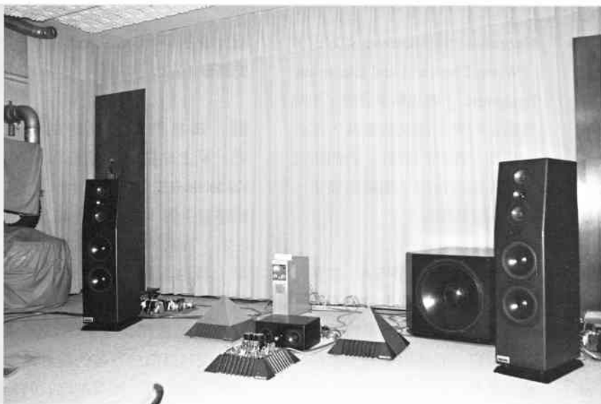
這間音響室地上擺著Pyramid PMA後級，單聲道各推一支喇叭，使用的喇叭是Jean-Claude Schlup自己設計製造的。這對喇叭從正面看沒什麼特別，但看到分音器時才會知道原來並不簡單。圖中還可以看到一個小中央聲道擺在地上，一個大超低音喇叭，這代表這些喇叭其實是整套設計的，可以當做二聲道使用，也可以作為多聲道。
